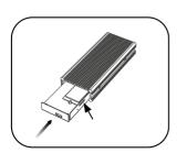
6. Schieben Sie die Platine mitsamt der SSD vorsichtig bis zum Anschlag in die Führungsschiene des Gehäuses. Achten Sie auf die korrekte Ausrichtung des LED Ausschnittsl
