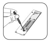
4. Drücken Sie die SSD dann vorsichtig nach unten und fixieren die M.2 mittels der gelieferten Schraube an der Platine.
